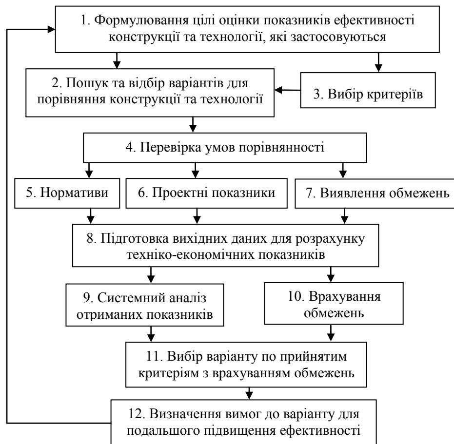
Рисунок 2.3 – Алгоритм оцінки показників ефективності конструкції та технології побудови композитних доків
