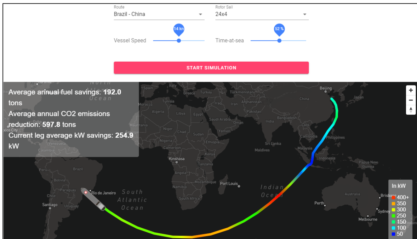
Рис 8.2 – Розрахунок ефективності від «Norsepower» [28] (результати приведені для переходу в обидві сторони)
