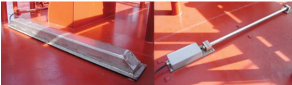
Рис. 6.9 Датчик «LBSG» для вимірювання деформації вздовж центральної лінії судна [32]
