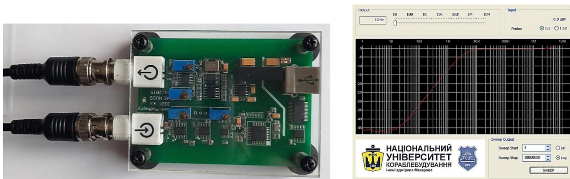
Рисунок 1 – Зовнішній вигляд (а) пристрою для зняття частотних характеристик та інтерфейс програмного забезпечення (б) для його використання
