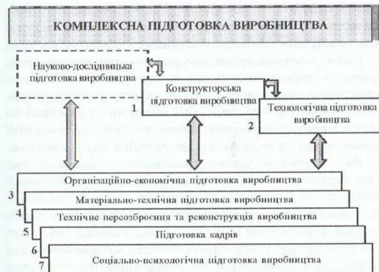
Рис. 2.1. Схема комплексної підготовки виробництва верфі
