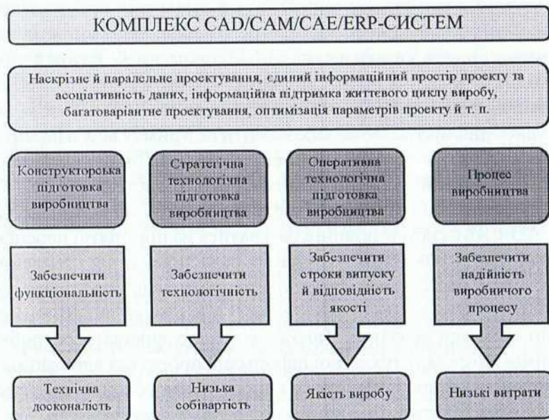
Рис. 1.4. Інтеграція програмних засобів CAD/CAM/CAE/ERP на верфі
