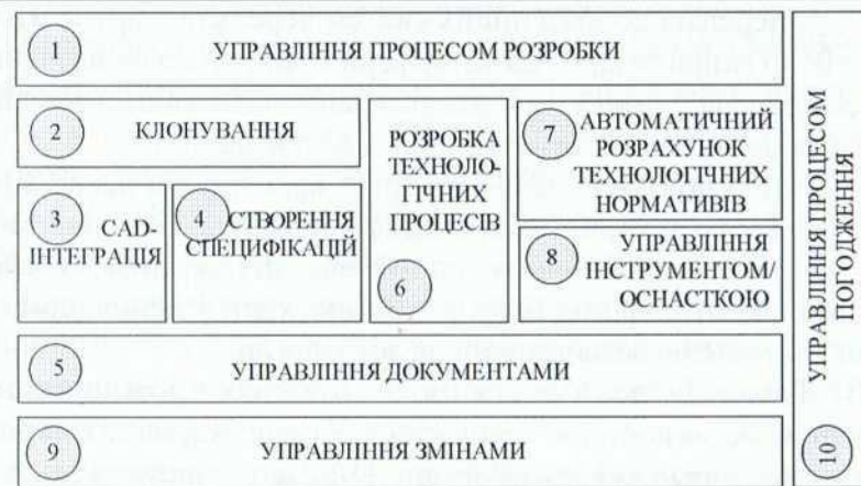
Рис. 3.17. Етапи процесу розробки конструкторсько-технологічної документації
