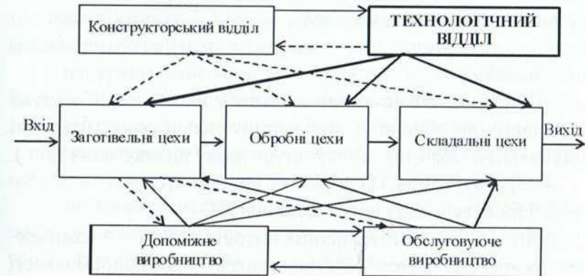
Рис. 3.8. Технологічні зв'язки структурних підрозділів верфі
