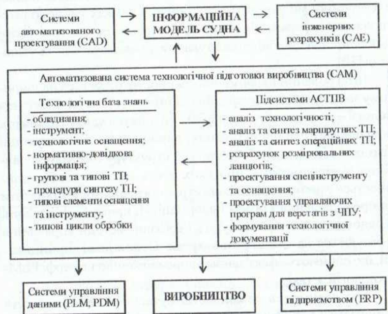
Рис. 1.3. Використання засобів PDM/CAD/CAM/ERP для створення єдиного інформаційного простору на верфі
