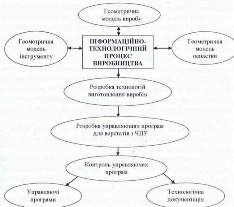
Рис. 3.9. Узагальнений інформаційно-технологічний процес виробництва верфі
