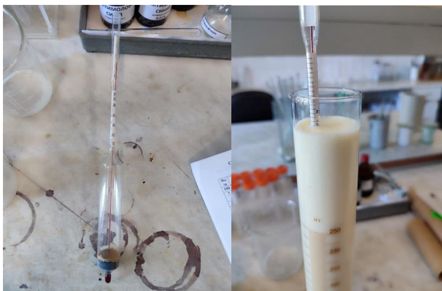
Рис. 4.1 Визначення густини молока ареометром
