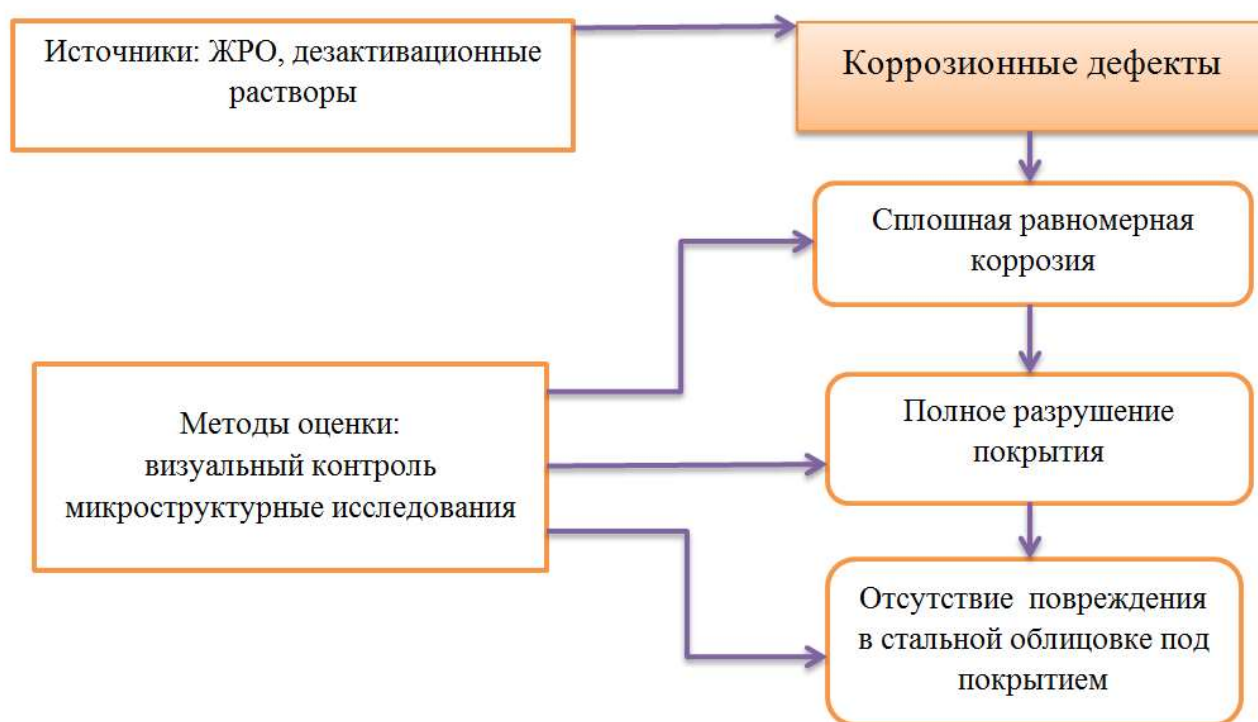
Рис. 3. Коррозионные дефекты композиционного защитного слоя конструкций биологической защиты
