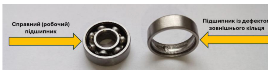
Рис. 1.6. Порівняння справного та дефектного підшипників типу 608ZZ
