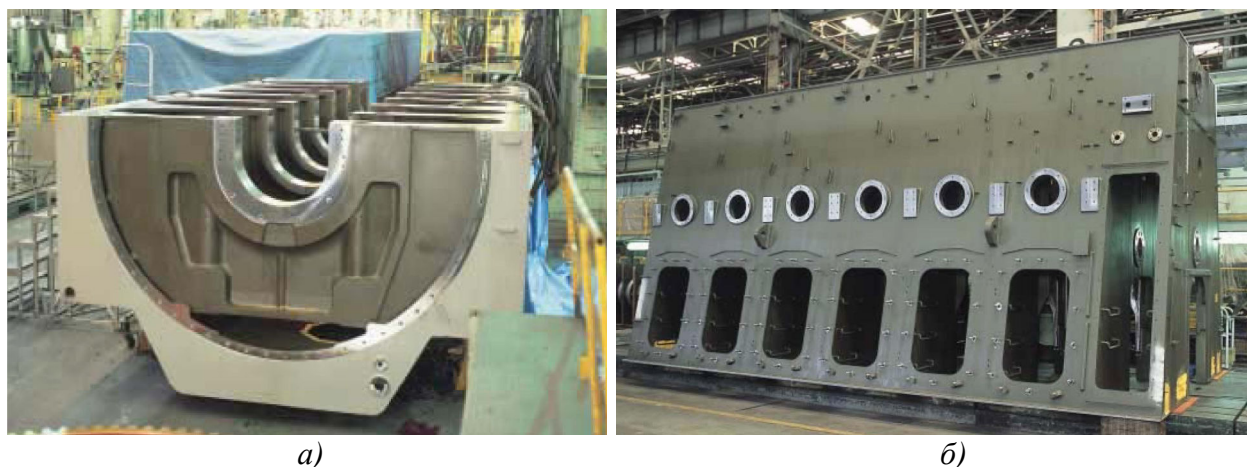
Рисунок 1.4 – Фундаментна рама (а) та коробка картеру (б) двигуна RTA72U-B
