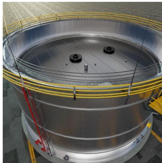
Рисунок 4.2. Резервуар із плаваючим дахом для зменшення випаровування нафтопродуктів: 1 – затвор, що ущільнює зазор між корпусом резервуара і плаваючим дахом; 2 – плаваючий дах; 3 – сифонна трубка для спускання зливових вод; 4 – сходи для огляду даху; 5 – сходи для підйому до плаваючого даху; 6 – шарнірна труба для спуску води; 7 – введення нафти в резервуар [38, 60]
