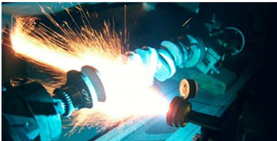
Рисунок 1.2 Процес відновлення КВ газотермічним напиленням, електродугова металізація (ЕДМ)
