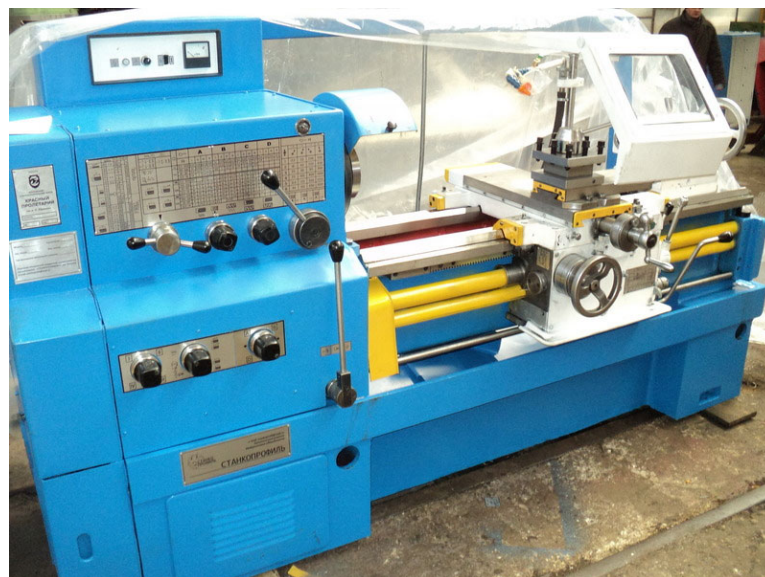
Рисунок 4.3 Токарно-гвинторізний верстат 16K20
