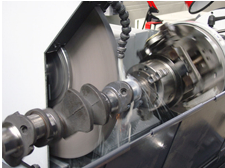
Рисунок 3.3 Процес шліфування з миттєвим охолодженням
