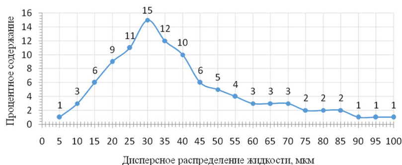
Рис. 6. Дисперсное распределение капель диаметром до 100 мкм
