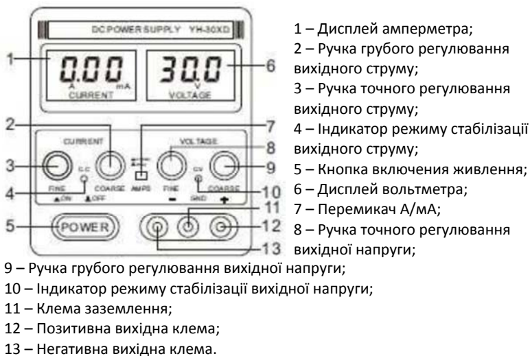
Рисунок 1.2 – Передня панель лабораторного джерела живлення
