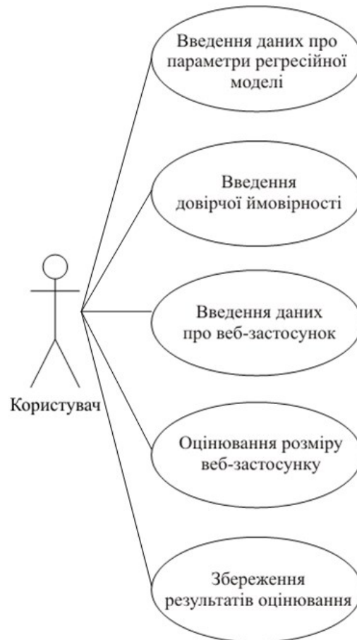
Рисунок 3.1 – Діаграма варіантів використання програми для оцінювання розміру веб-застосунків, що створюються мовою Python
