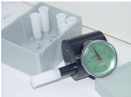
Рис. 11.1. Механічний спірометр – ССП – сухий портативний, призначений для вимірювання об'єму видихуваного повітря з метою визначення параметрів життєвої ємності легень (діапазон показань – від 0 до 6,5 л, ціна поділки – 100 мл, габаритні розміри – 71 \times 50 \times 66 мм, маса – 150 г)
