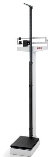
Рис. 2.2. Механічні медичні ваги з ростометром: 1 – загальний вигляд ваг; 2 – штанга для вимірювання зросту
