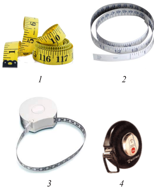
Рис. 2.6. Варіанти полотняних (1), пластикових (2, 3) і металевих (4) міліметрових вимірювальних стрічок
