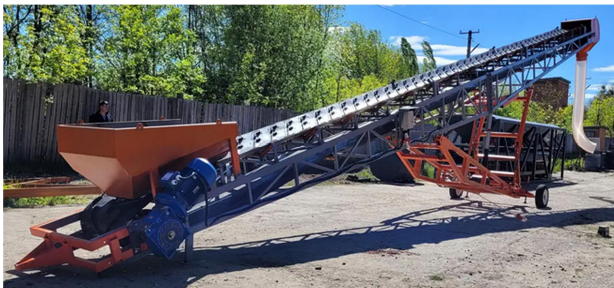
Загальний вид стрічкового пересувного конвеєра типу БО 16080 із зазначенням складових частин
