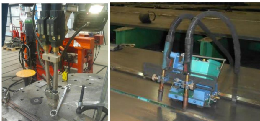
Рис. 2.4. Устаткування для дводугового зварювання
