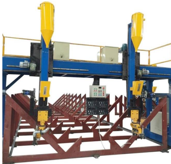
Рис. 1.4. Автоматична зварювальна машина портального типу
