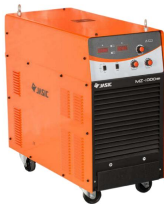
Рис. 3.1. Зварювальне джерело інверторного типу Jasic MZ-1250 (M310)
