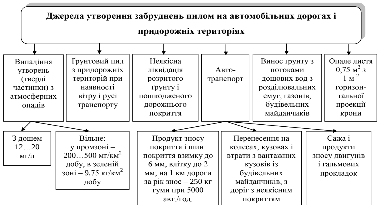
Рис. 2.1 – Джерела утворення пилових забруднень на автомобільних дорогах та придорожніх територіях
