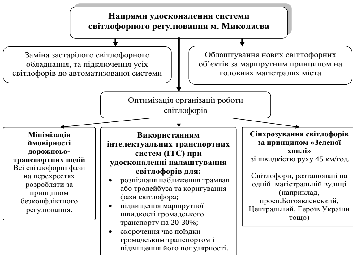
Рис. 6.11 – Напрями удосконалення системи світлофорного регулювання м. Миколаєва [64]
