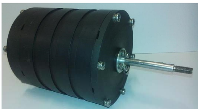
Рисунок 2.2 – Зовнішній вигляд електродвигуна самохідного підводного апарата
