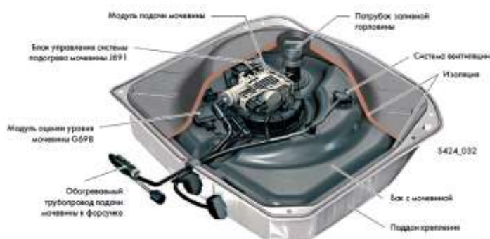
Рис. 3.12 – Бачок для зберігання та подачі AdBlue®
