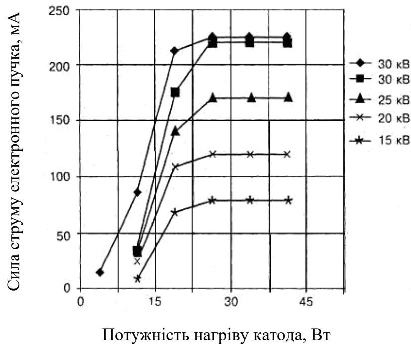
Рисунок 3.6 Накальні характеристики електронної гармати з дисковим (верхня крива) і Т-образним (інші) катодом з монокристалічного гексабориду лантану (прискорююча напруга в діапазоні 15...30 кВ)
