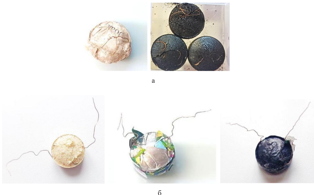
Рис. 4. Досліджувані зразки з мідним дротом : а – стандартизовані «таблетки» зі впресованим мідним дротом; б – стандартизовані «таблетки» з витягнутими «вусиками» мідного дроту
