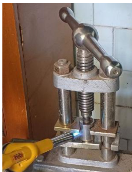
Рис. 3. Процес нагрівання газовим пальником досліджуваного компоненту
