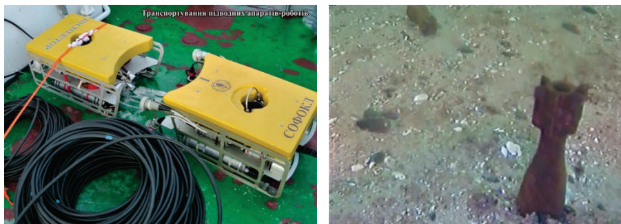
Рисунок 1 – Підводні апарати виробництва Науково-дослідного інституту підводної техніки Національного університету кораблебудування імені адмірала Макарова, залучені до обстеження акваторій Чорного моря
