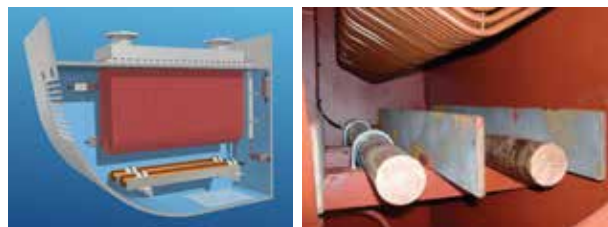
Рис. 5. Схема та зовнішній вигляд розміщення анодів системи ICAF
