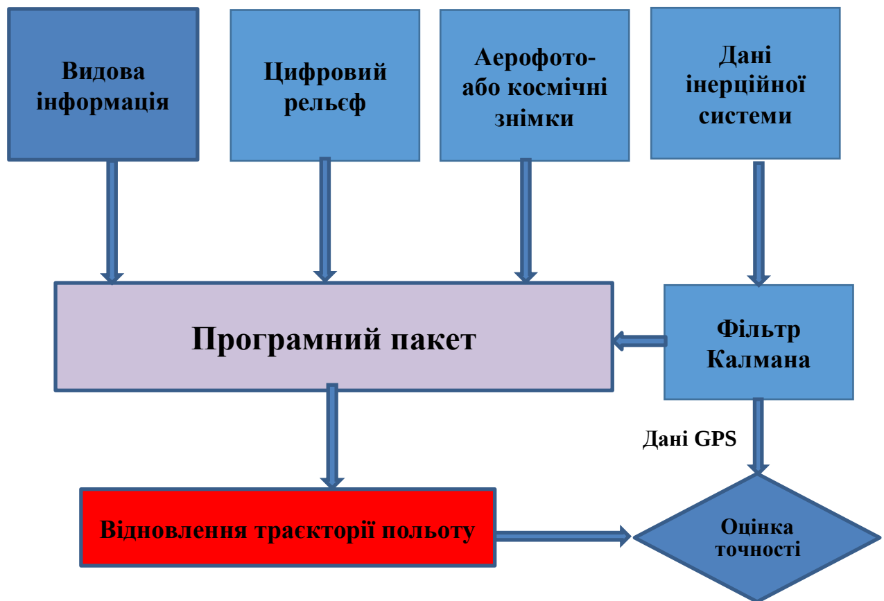
Рис. 1. Узагальнена схема навігації БПЛА
