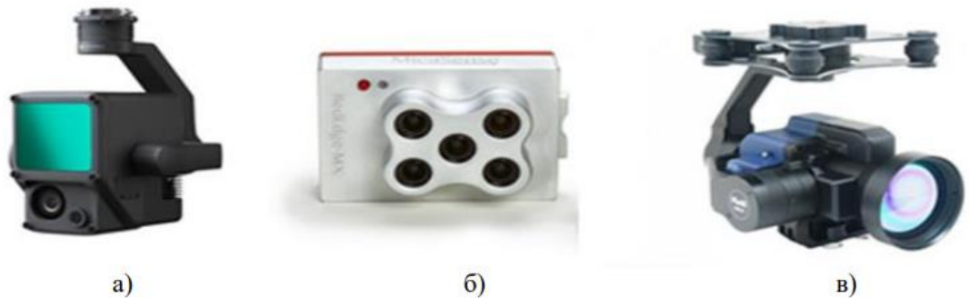
Рис.6. Апаратура розвідки (спостереження) БПЛА: а) RGB-камера; б) багатоспектральна камера; в) інфрачервона камера
