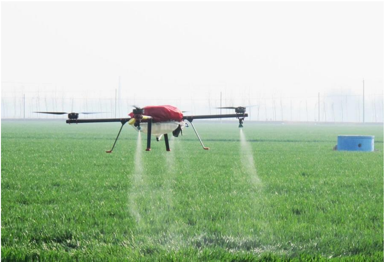
Рис.9. Використання дронів для внесення мікродобрив ультрамалооб'ємним методом
