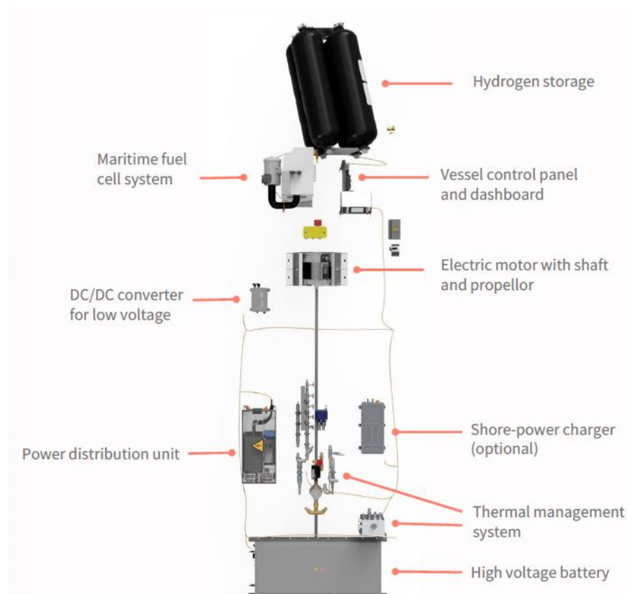
Рисунок 1.10 – Розташування основних елементів водного таксі «MSTX 22» [13]
