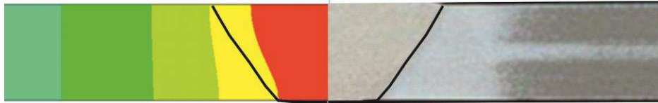
Рисунок 4.4. Порівняння експериментальних і розрахункових перетинів шва (час зварювання 30 с)
