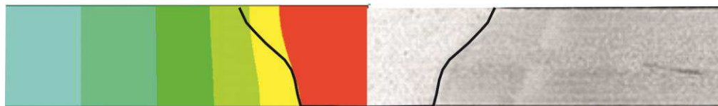
Рисунок 4.7. Порівняння експериментальних і розрахункових перетинів шву
