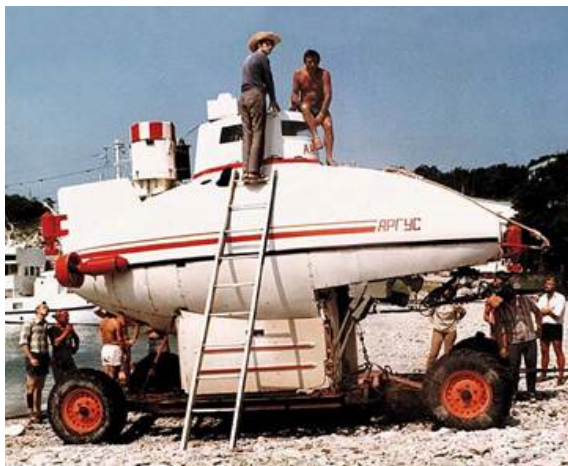
Рис. 1.60. Подготовка подводного аппарата "Аргус" на берегу
