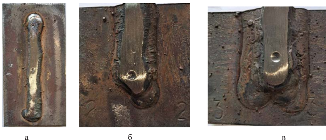
Рис. 1. Особливості формування зварного з'єднання: а – 1 шар наплавлення; б – 2 шари наплавлення; в – 3 шари наплавлення
