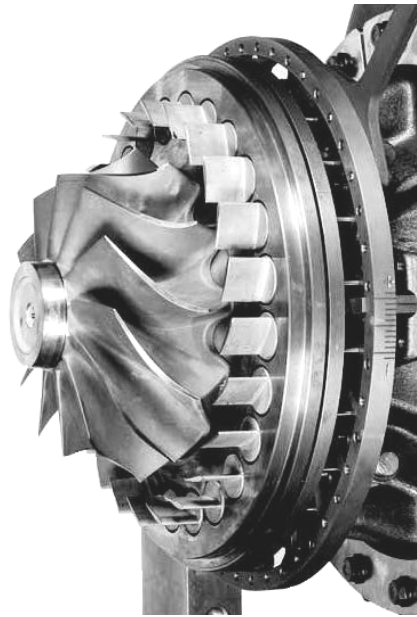
Рисунок 2.4 – Регулюємий сопловий апарат радіально-осьової турбіни
