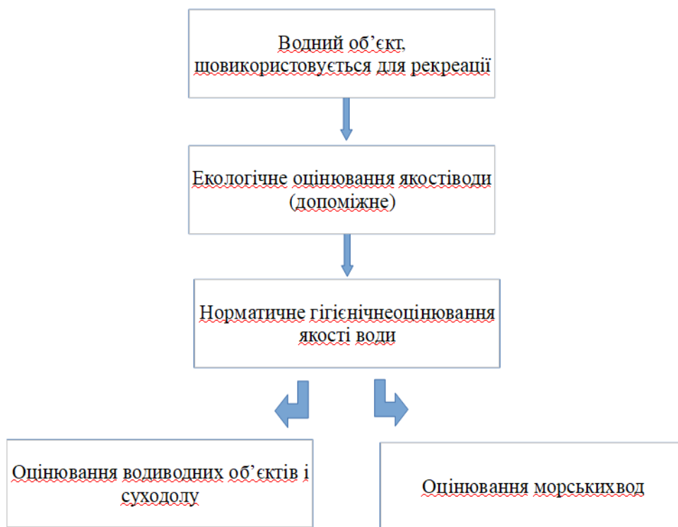
Рисунок 2.1 – Алгоритм оцінювання якості води водного об'єкта для рекреаційних цілей
