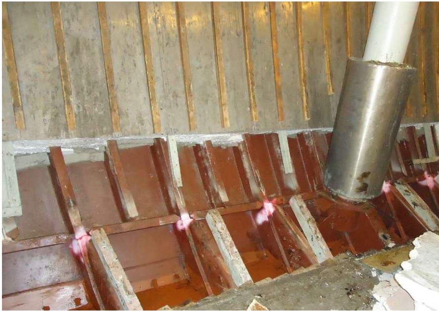
Рисунок 4.1.2 – Тріщини втоми в носовому трюмі
