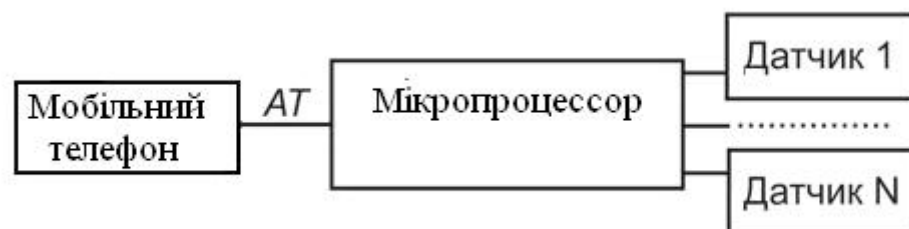
Рис.2. стала система: мобільний телефон - мікропроцесор - датчик (датчики)
