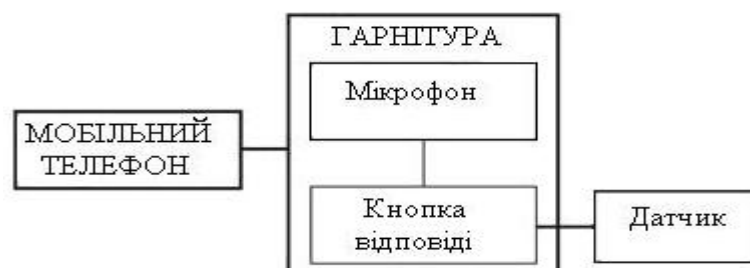
Рис.1. Найпростіша система: мобільний телефон - гарнітура - датчик
