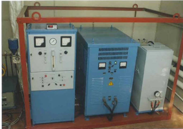
Рисунок 2.4 Комплекс плазмового напилення УПУ-3Д
