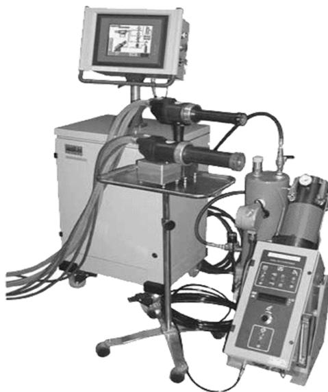
Рисунок 1.7 Установка Intelli-Jet фірми UniqueCoat Technologies
