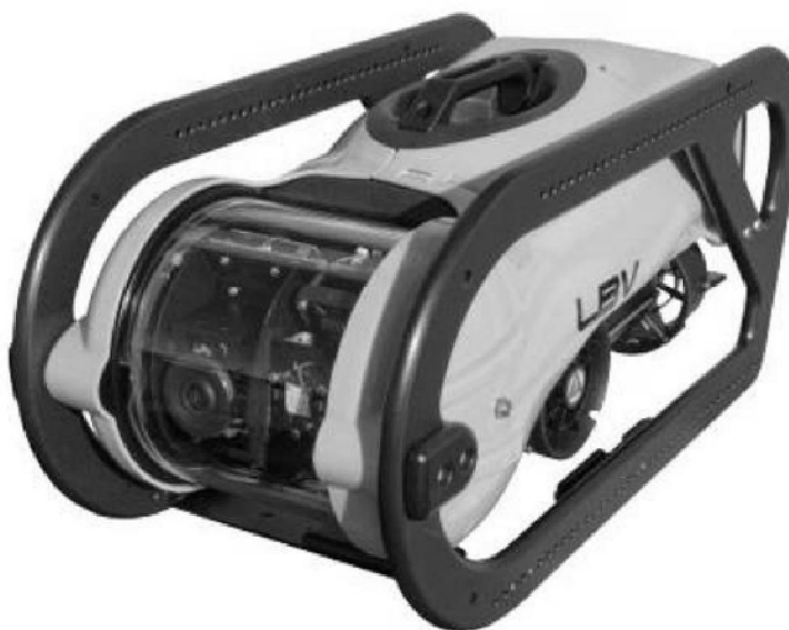
Рисунок 1.7 – Конфігурація рушійно-рульового комплексу у поєднанні двох маршових рушіїв з одним вертикальним та одним лаговим рушіями
