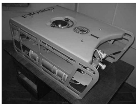
Рисунок 1.5 – Конфігурація рушійно-рульового комплексу у поєднанні двох маршових рушіїв з одним вертикальним
