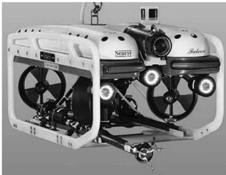
Рисунок 1.8 – Конфігурація рушійно-рульового комплексу у поєднанні чотирьох векторних рушіїв у горизонтальній площині з одним вертикальним рушієм
