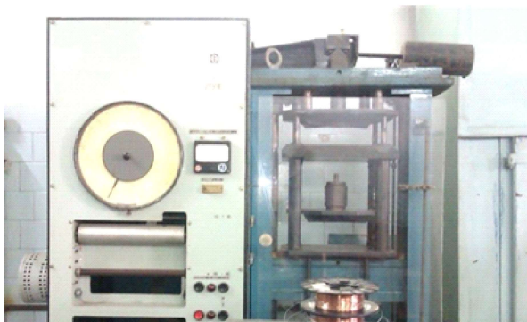
Рис. 7.2. Лабораторна установка для пресування порошків
