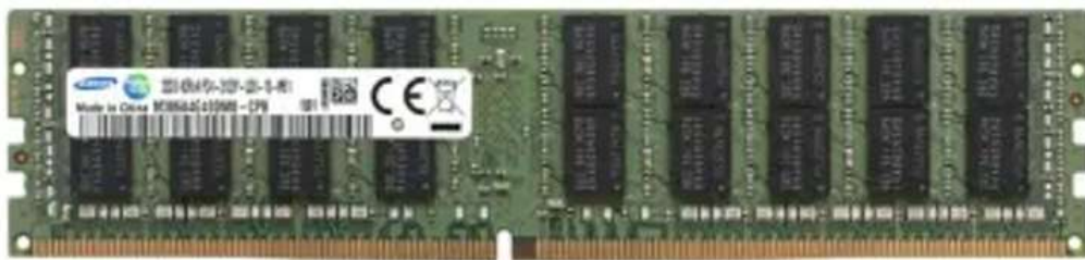
Рис.2.11 – Оперативна пам'ять сервера 32 DDR4R-2133 LRDIMM M386A4G40DM0-CPB Samsung x6
