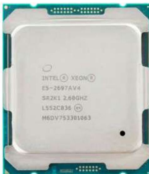
Рис.2.14 – Процесор сервера E5-2697A v4 Хеон
