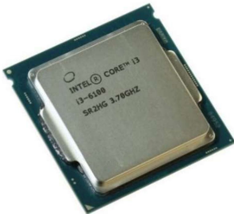
Рис.2.15 – Процесор офісного ПК Core i3 6100
