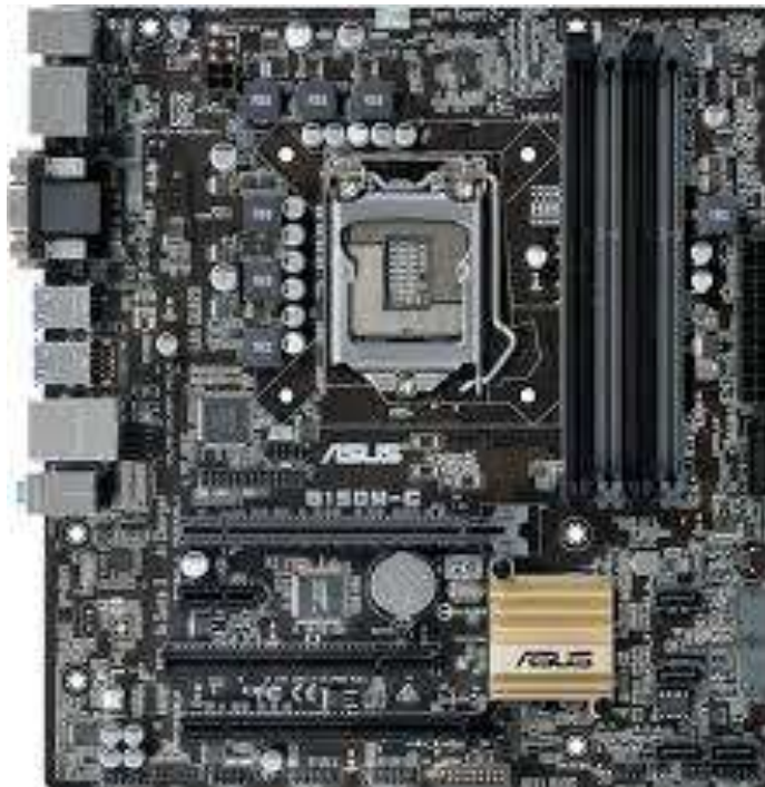
Рис.2.17 – Материнська плата офісного ПК Asus B150M-C
