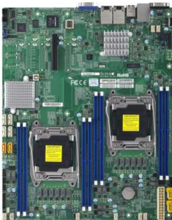
Рис.2.13 – Материнська плата сервера MBD-X10DRD-iNT Supermicro Dual socket 8 DIMM slots 2400/2133/1866/1600MHz ECC DDR4 SDRAM
