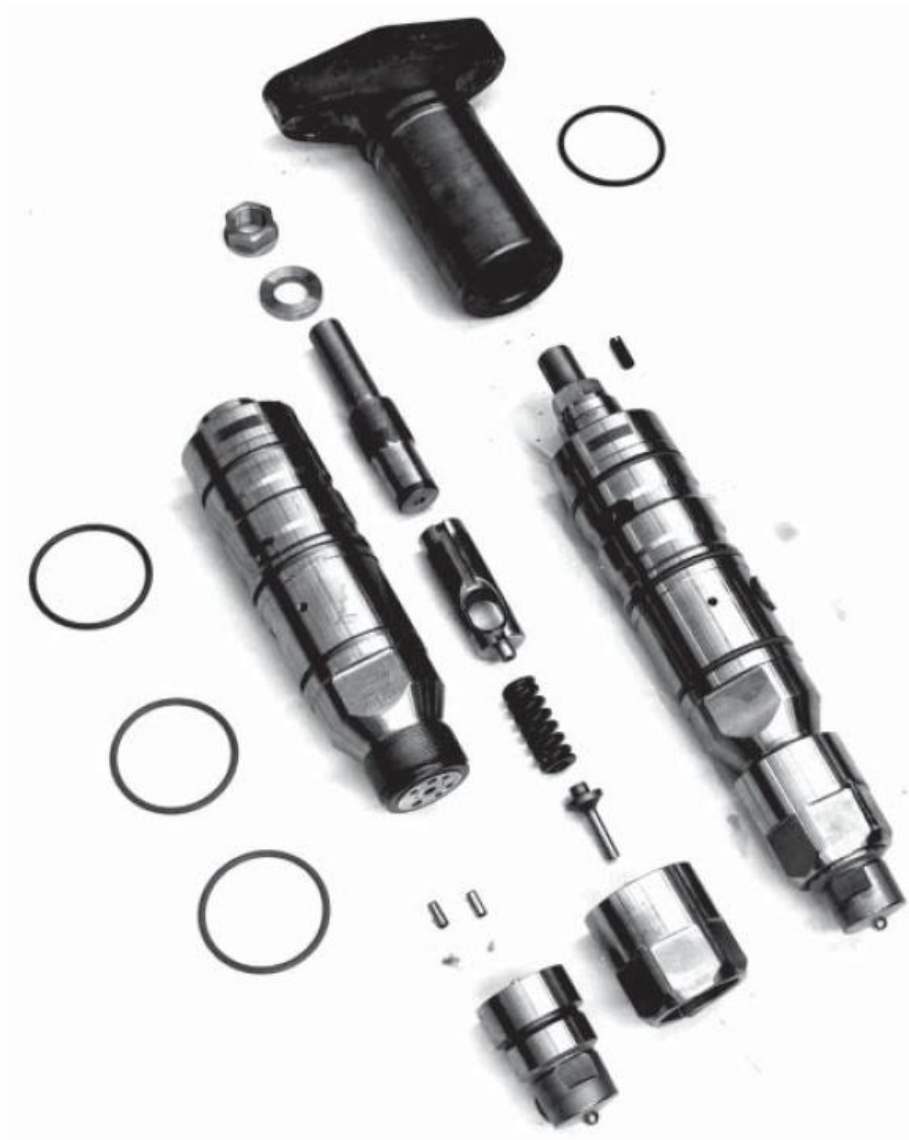
Рисунок 1.11 – Основні елементи паливної форсунки дизеля 6ЧН 58/64 (MAN B&W L58/64)
