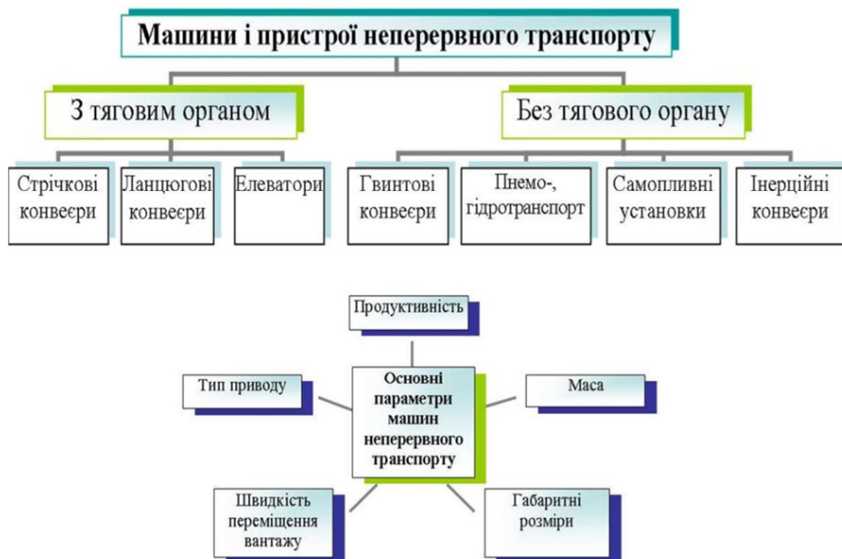
Рисунок 1.2 - Класифікація машин неперервного транспорту
