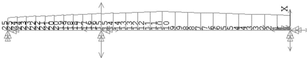
Рис. 3. Скінчено-елементна модель бортового перекриття із прикладеним навантаженням
