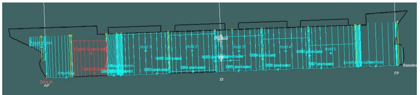
Рисунок 2.7 – Графічне відображення посадки судна з танками та їх заповненням при затопленні відсіків
