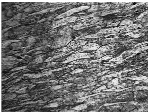
Рис. 4.8. Мікроструктура технічно чистого заліза після холодної динамічної та наступної статичної деформації, \times 250
