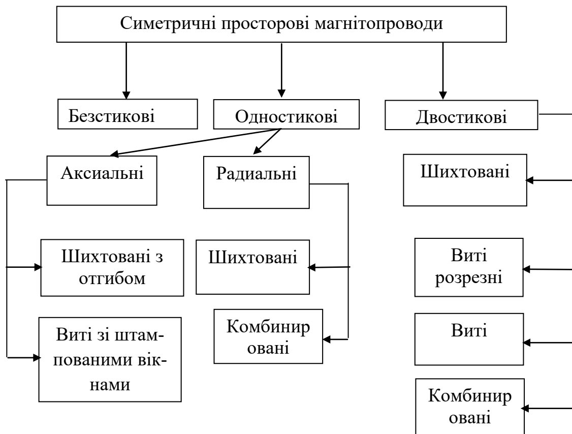
Рис. 3.3. Класифікація симетричних просторових магнітопроводів для трифазних трансформаторів
