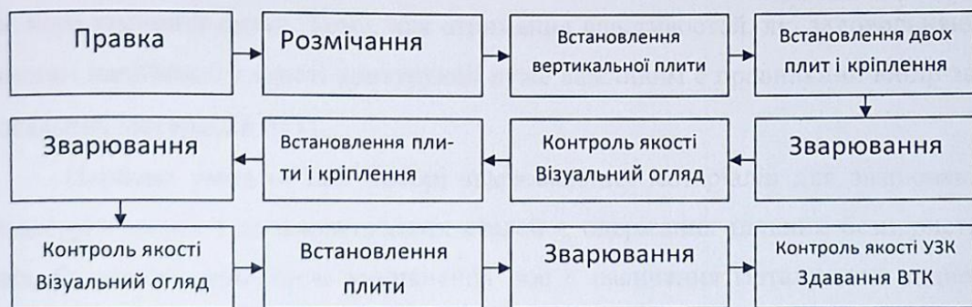
Мал. 3.1. Схема технологічного процесу виготовлення кронштейну
