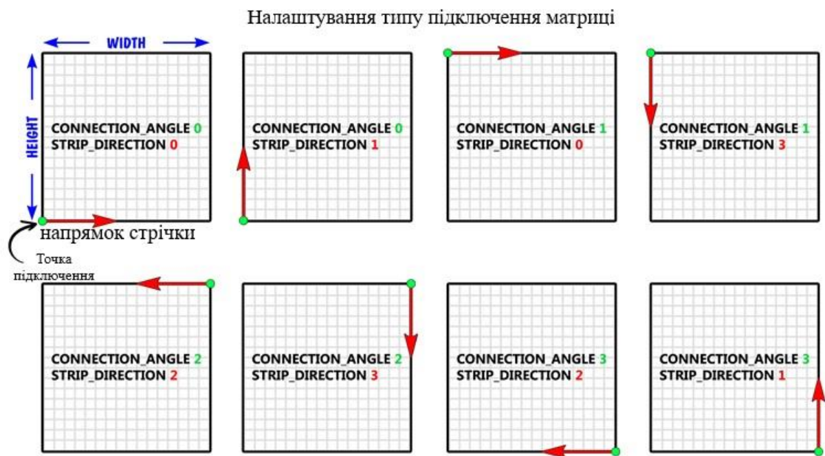
Рисунок 2.3 – Варіанти топології прокладання інформаційної шини при конструюванні матриць довільної роздільної здатності
