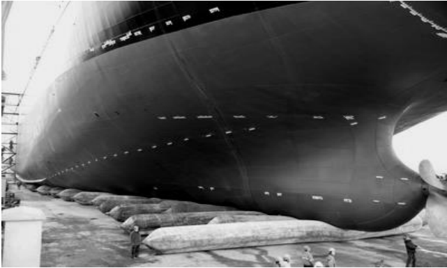
Рисунок 1 – Спуск судна на балонах
