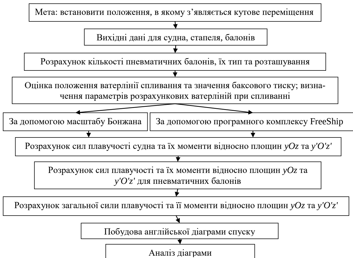
Рисунок 6 – Схема алгоритму розрахунку спуску судна з похилого поздовжнього стапеля на пневматичних балонах
