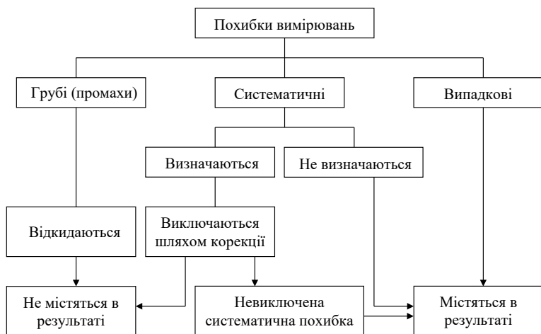
Рис. 1.3. Класифікація похибок вимірювань за характером їх прояву
