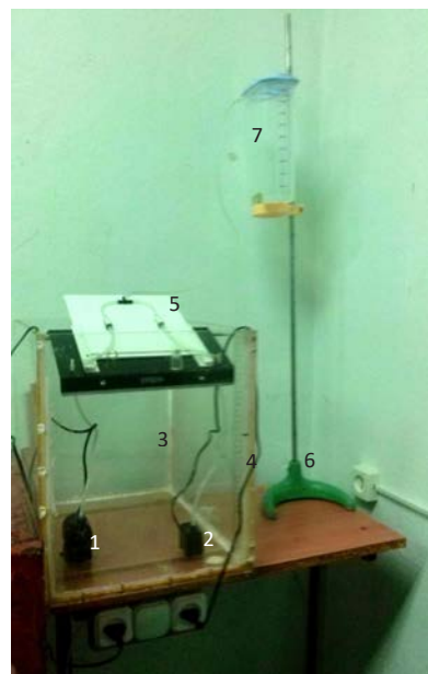
Рис. 1. Схема і зовнішній вигляд лабораторного стенду: 1 – насос № 1; 2 – насос № 2; 3 – вхідна ємність; 4 – шкала; 5 – клік-модуль; 6 – стійка з полицею; 7 – приймальна ємність зі шкалою; 8 – таймер; 9 – термометр
