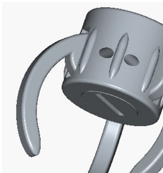
Рисунок 2.8 – Трипальцевий захват для робота-маніпулятора Niryo One
