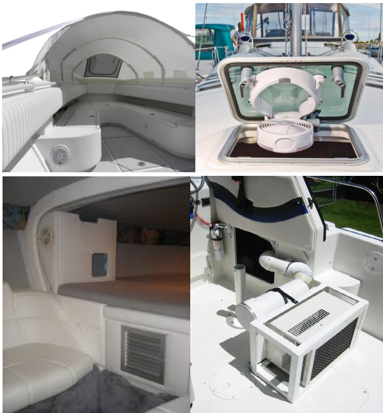
Рис. 23. Елементи яхтової вентиляційної системи
