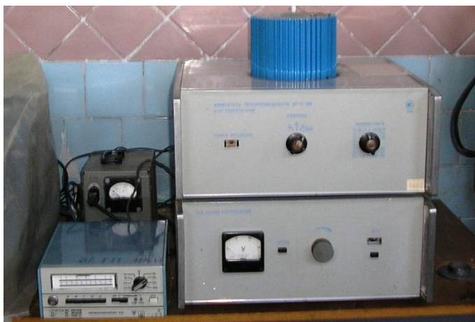
Рисунок Б.7 – Вимірювач теплопровідності ИТ-Л-400
