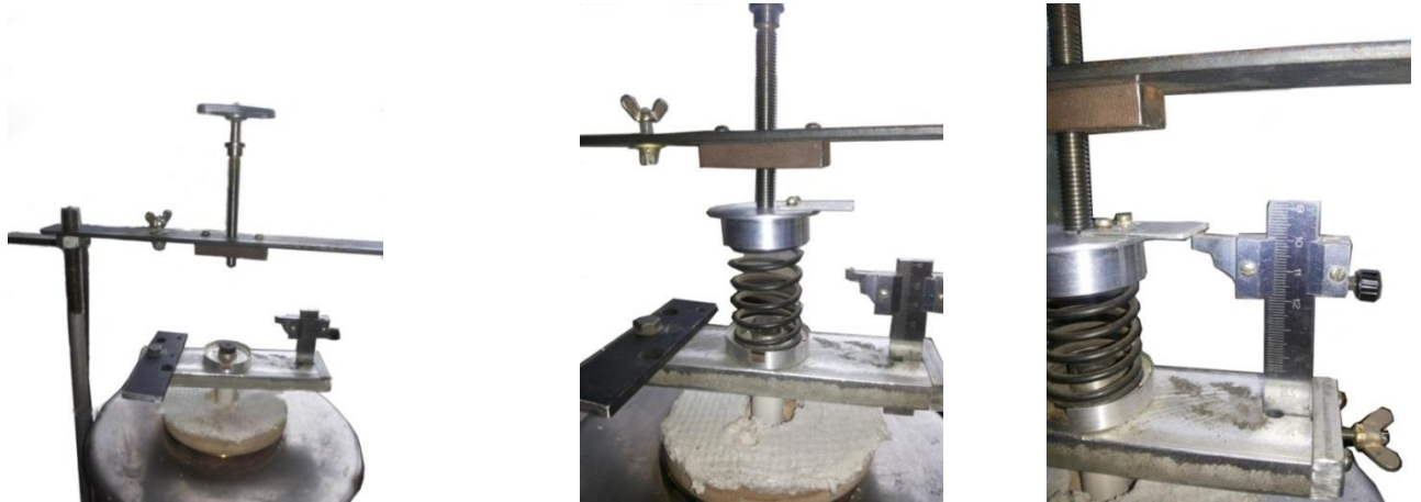
Рисунок В.2 – Прикладання тиску пресування
